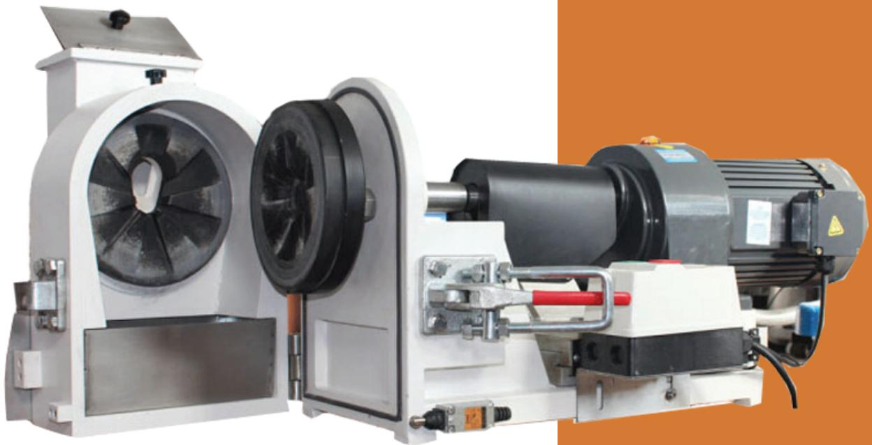
Die DP100 ist für das Vor- und Feinmahlen von mittelharten und harten spröden Feststoffen geeignet. Sie kann Proben zu Partikeln von einer Größe von 100 µm sehr schnell mahlen. Sie ist das Ideale Gerät für die Umweltanalytik von Boden- und Betonproben aller Arten.
