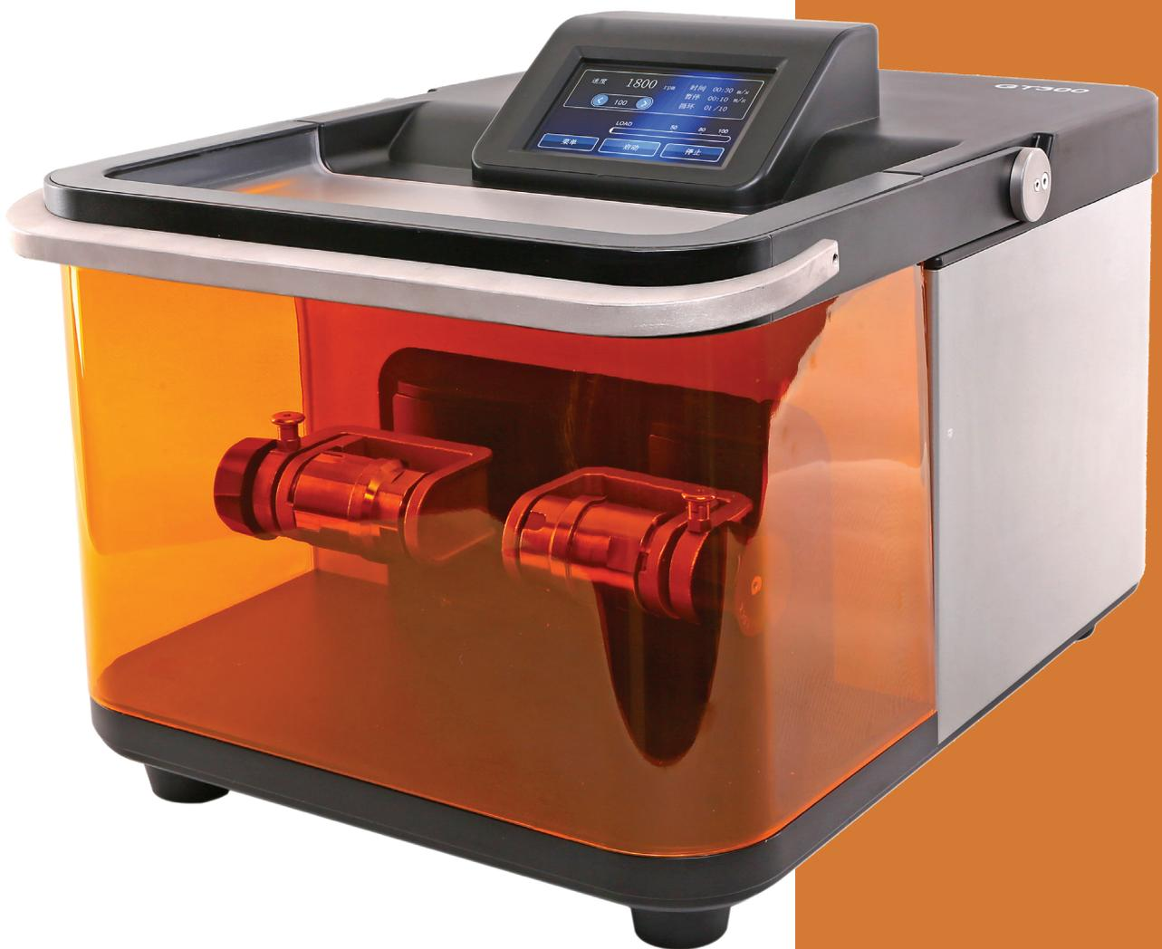
Die Vibrationskugelmühle GT300 ist für moderne Laboranwendungen konzipiert. Sie kann kleine bis sehr kleine Menge mit einem hohen Durchsatz an Proben bewältigen. Zum Beispiel Pflanzen, Tiergewebe, Humangewebe für die Forensik und kleine Probenmengen, trocken, nass oder in kryogenem Zustand.
